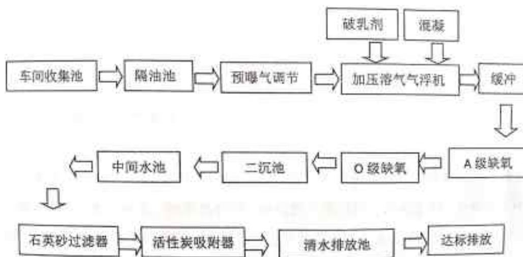
图 3-1 污水处理工艺流程
