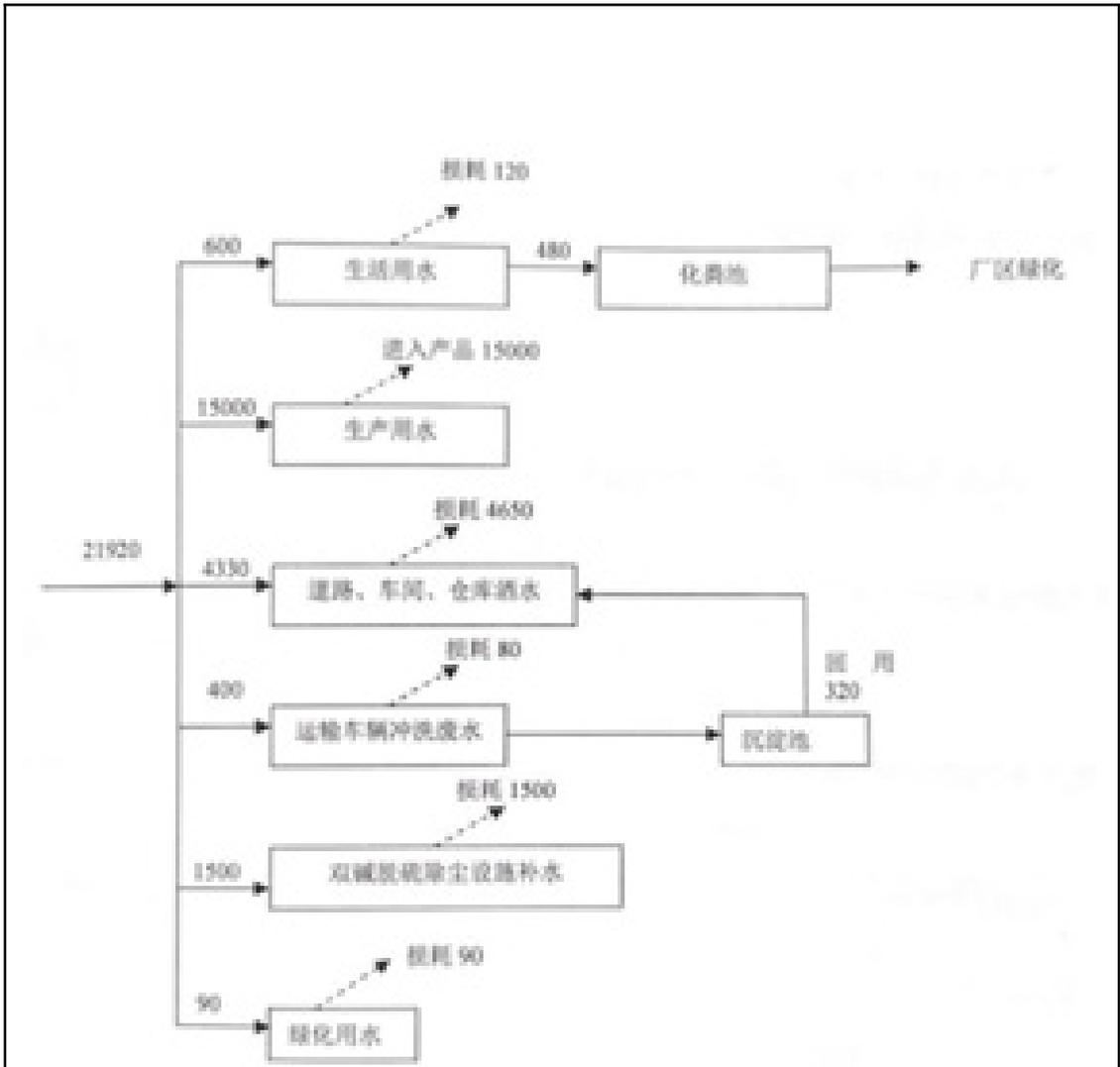
图 2-1 用水平衡图 (m³/a)
