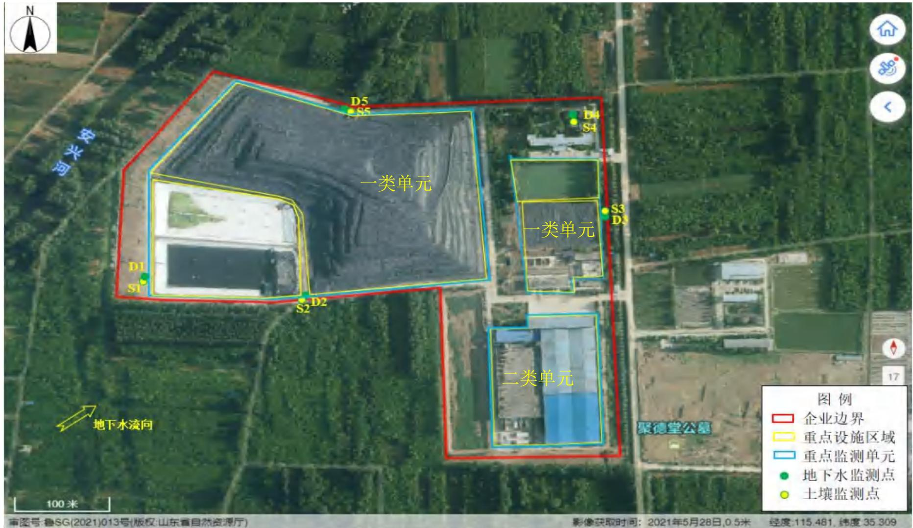
图6.3-1 土壤和地下水监测点位设置平面图
